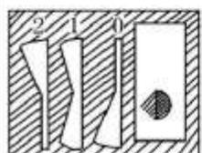
**Выключатель потолочных ламп и хвостовых фонарей**
