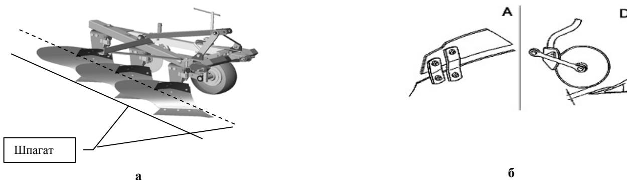
Рис 7 Установка рабочих органов плуга а) проверка расположения лемехов; б) установка углоснима и дискового ножа
